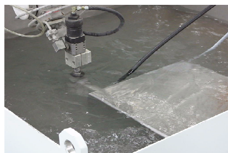
Fig.2 ウォータージェットによる水中切断
