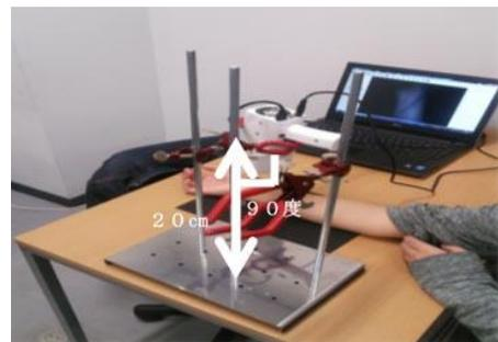
図2 CIGS カメラによる血管撮像実験
