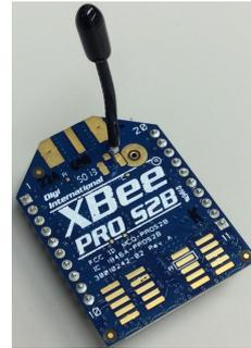
図3 XBee ZB RF モジュール
