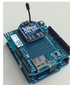
図5 XBeeモジュールとArduinoの連結形態
