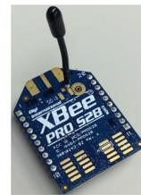
図3 XBee ZB RF モジュール
