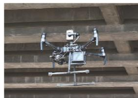
ドローンによる機載の3次元計測
