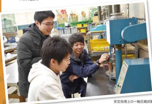
安定処理土の一軸圧縮試験
