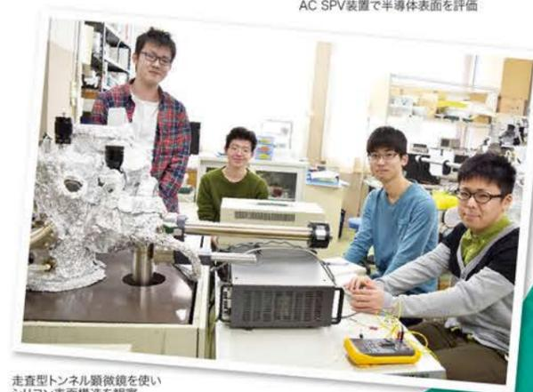
走査型トンネル顕微鏡を使いシリコン表面構造を観察
