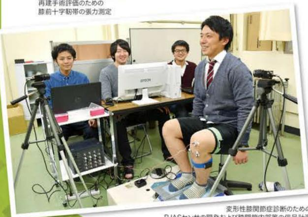
変形性膝関節症診断のためのBJASセンサの開発および膝関節内部等の信号計測
