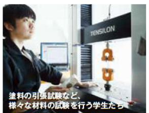
塗料の引張試験など、様々な材料の試験を行う学生たち
