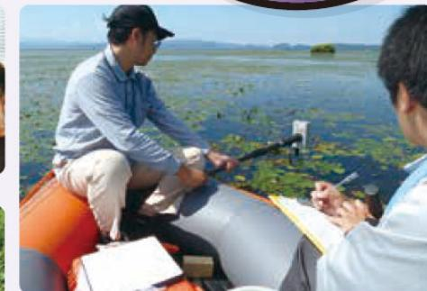
猪苗代湖で水生植物の反射特性を計測する
