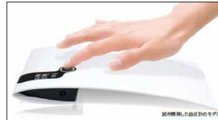
試作開発した血圧計のモデル
