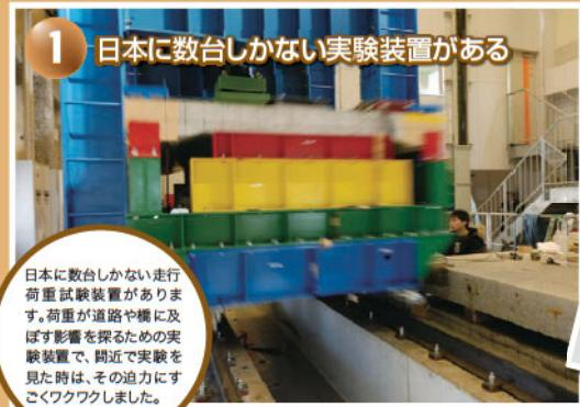
日本に数台しかない走行荷重試験装置があります。荷重が道路や橋に及ぼす影響を探るために実験装置で、間近で実験を見た時は、その迫力にすくすくワクワクしました。
