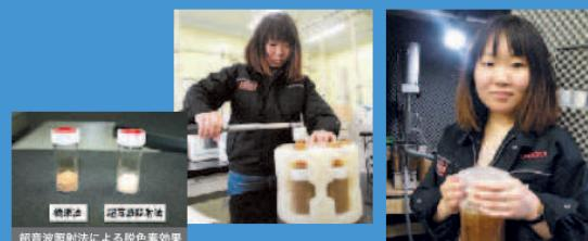
カニクチクラ粉末にクエン酸を加え超音波を4時間照射します。吸引ろ過した後に蒸留水で洗液が中性になるまで洗浄します。試料を真空凍結乾燥し脱灰完了。その後、脱タンパク質、脱脂を行った結果、従来法と同じくらいの収率が得られました。大幅な脱灰時間の短縮と、脱色素の効果、塩酸を使用しないことにより有害廃液の削減が可能になりました。
