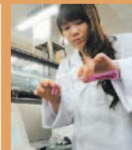
1年間にどのくらいの負荷が発生しているのか負荷量を調べる水質調査を行いました。水の流速とその断面積で流量を調べます。水を採取し、どんな成分が含まれているかを研究室で分析。河川の汚濁物質である窒素、生活雑排水に含まれるリンなどの成分を調べます。古川池に流入してくる窒素、リンの濃度は共に流下に伴って減少することから、栄養塩類の植生への吸収や沈降、土壤への吸着等、池内での浄化作用が働いていることがわかりました。
