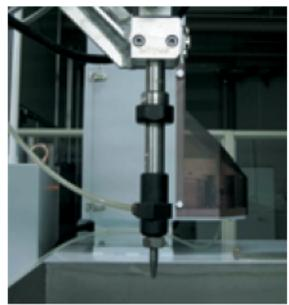
水を高圧にして噴射する「ウォータージェット」は、材料の加工などさまざまな分野で利用されています。ウォータージェット加工は、環境に及ぼす負荷が小さく、他の方法では困難な材料加工が実現できるなど、利点がたくさんあります。しかし、ウォータージェットは超高速の流れであるため、まだまだ解明されていない点が多く残されています。流体工学研究室では、ウォータージェット技術の有効利用を図るため、高速度ビデオと画像処理手法を用いて流れの様相を解明する研究を行っています。ウォータージェットの周囲に無数の気泡が発生するキャビテーションジェットの場合には、流れの内部を実験的に観察することが困難です。このため、CFD手法（流れの運動に関する方程式をコンピュータで解く）を用いて流れの様相を解明
