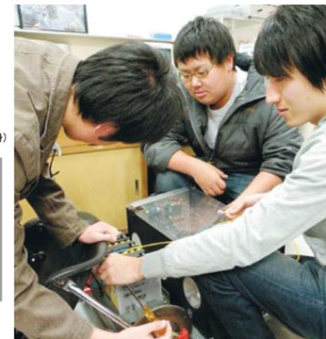
源として燃料電池とともに、バッテリーを使用。燃料電池を積み、発電した電力で制御装置を起動させ、カートを走行させる…という仕組みです。
