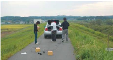
実際に吉田川に行き、河口11kmから17kmの地点にかけて、右岸堤防9地点で常時微動の測定を行いました。地面の上に揺れを測定する機器を置き、3分間測定し、パソコンに記録します。研究室に戻って盛土・支持地盤系の1次元地震応答解析法を用いて解析を行いました。
