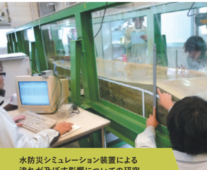
水防災シミュレーション装置による 流れが及ぼす影響についての研究
