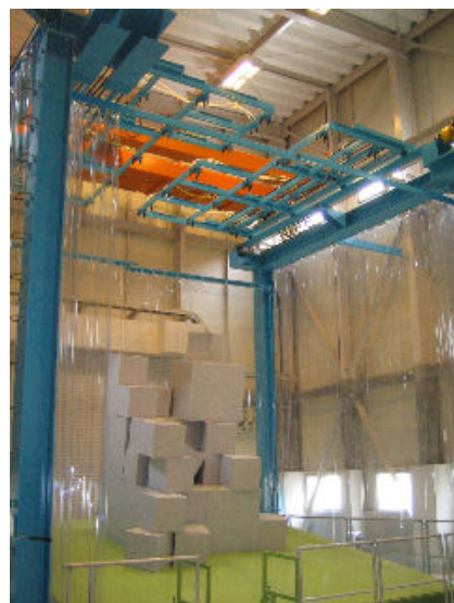
図-6.30 人工降雨装置を持つ大型地盤傾斜台
