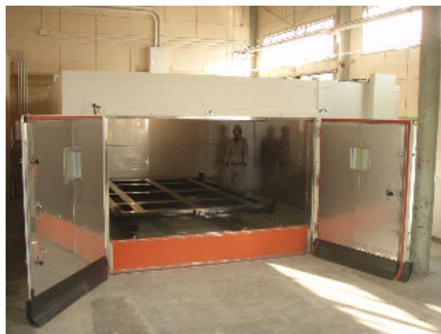
図-6.33 大型環境試験装置
