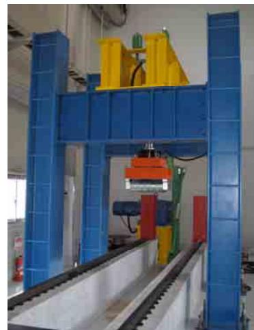
図-6. 34 走行荷重試験装置
