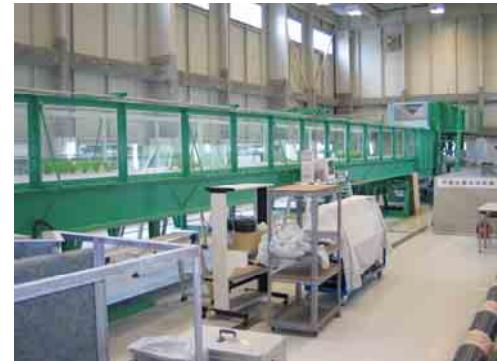
図-6. 31 循環式傾斜可変
