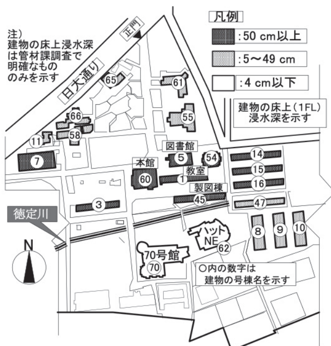
図4 日本大学工学部 建物の浸水被害
