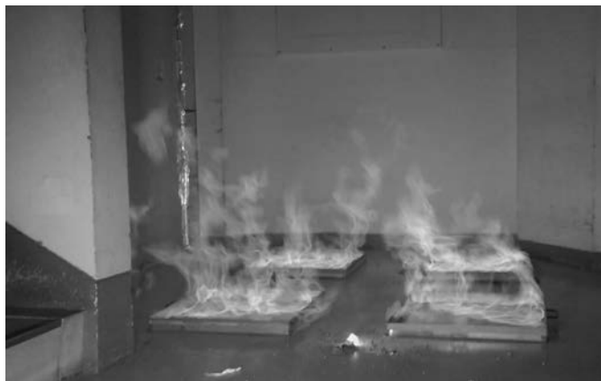
階段内の火元の様子(一人掛けソファ程度の発熱量)
