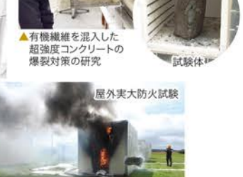
▲屋外実大防火試験
