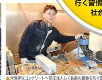
▲含浸剤をコンクリートへ高圧注入して鉄筋の腐食を防ぐ研究
