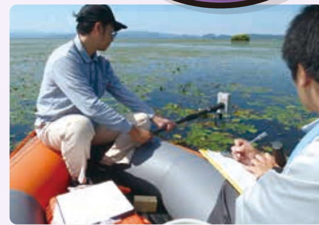
猪苗代湖で水生植物の反射特性を計測する
