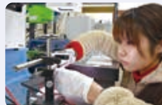
色素増感太陽電池の変換効率の測定
