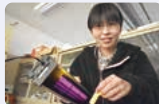
紫外線を照射して溶液の蛍光を調べる
