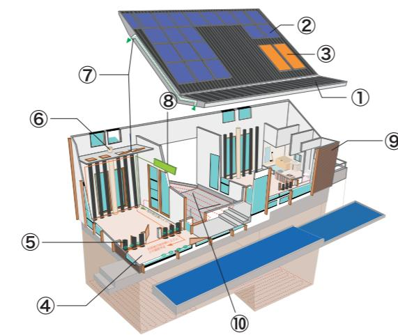
①バタフライ屋根 ②太陽光発電器 ③太陽熱採集器
