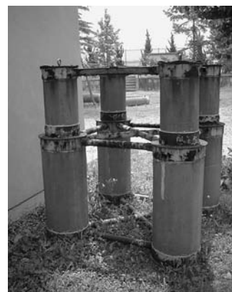
浮函基礎模型（1/50）の現況
